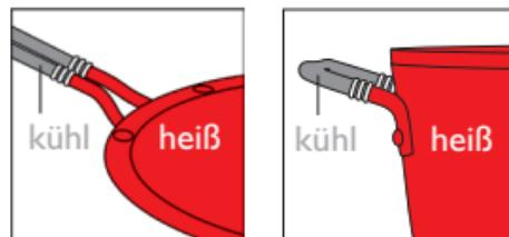
Die O-Ringe aus Silikon an den Griffen nicht der Gasflamme aussetzen. Ein Verlust der O-Ringe bedeutet keine Einschränkung der Funktion der Hitzepuffer und des Kochgeschirrs.
