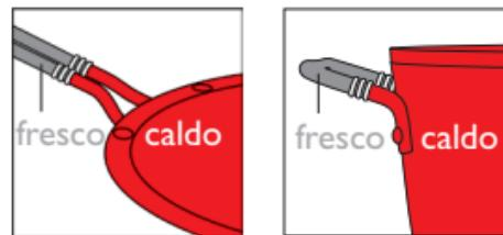
Non esporre l'anello in silicone delle maniglie sulla fiamma. La perdita delle guarnizioni non limiterà l'efficacia dei dispersori di calore o della padella.
