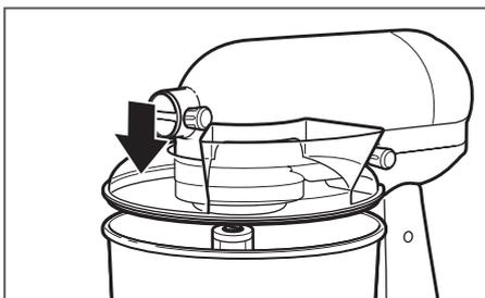
(OPCIONAL) Para montar el escudo vertedor\*: Deslice el escudo vertedor\* desde la parte delantera del robot de cocina hasta dejarlo centrado sobre el bol. El borde inferior del escudo vertedor\* debe encajar dentro del bol. El conducto para verter debe quedar a la derecha de la toma de accesorios (mirando de frente al robot de cocina).
