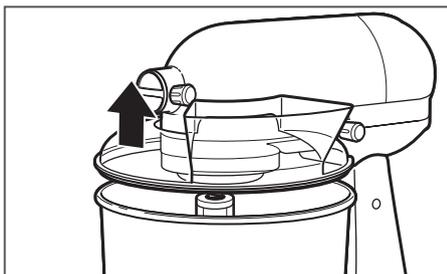
**(OPCIONAL)** Para desmontar el escudo vertedor\*: Levante la parte delantera del escudo vertedor\*, separándolo del borde del bol, y aléjelo del robot de cocina.
