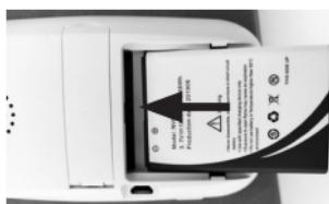
3. Richiudere il coperchio del vano batteria sul retro dell'unità genitore finché non scatta in posizione.
