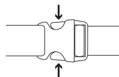
Drücken Sie zum Öffnen des Steckverbinder gleichzeitig die Entriegelungen, wie nebenstehend abgebildet.
