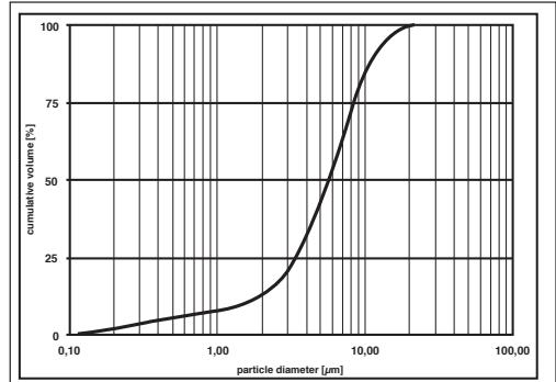
Les mesures ont été effectuées avec une solution de chlorure de sodium, à l'aide de la méthode par diffraction laser.
