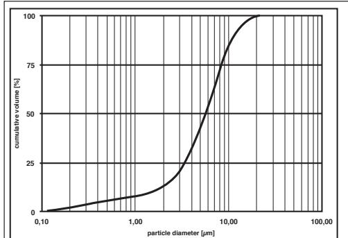
Le misure sono state effettuate con una soluzione al cloruro di sodio, per mezzo di un metodo a diffrazione laser.
