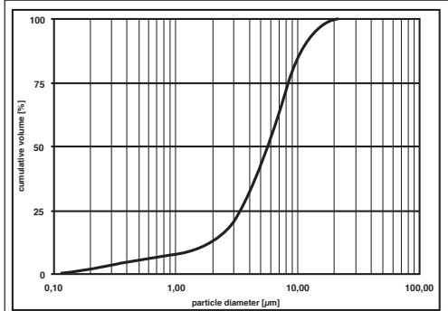
Las mediciones se han realizado con una solución de cloruro sódico utilizando un método de difracción láser. Probablemente de esta manera el diagrama no se puede aplicar en suspensiones o con medicamentos muy viscosos. El fabricante del medicamento correspondiente puede facilitarle más información al respecto.
