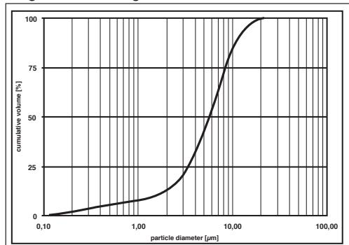
Die Messungen wurden mit einer Natrium-Chlorid-Lösung mittels Laser-Diffraktions-Methode durchgeführt.
