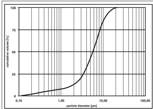
Измерения производились с использованием раствора хлорида натрия методом лазерной дифракции.
