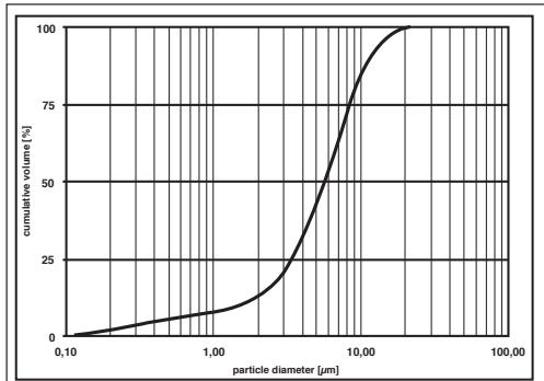
Ölçümler sodyum klorür çözeltisi ile lazerdifraksiyon-yöntemi aracılığıyla gerçekleştirildi.
