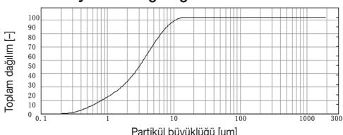
Ölçümler sodyum klorür çözeltisi ile lazerdifraksiyon yöntemi aracılığıyla gerçekleştirildi.
