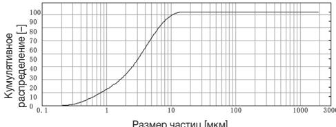
Измерения производились с использованием раствора хлорида натрия методом лазерной дифракции.
