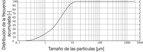
Las mediciones se han realizado con una solución de cloruro sódico utilizando un método de difracción láser. Probablemente de esta manera el diagrama no se puede aplicar en suspensiones o con medicamentos muy viscosos. El fabricante del medicamento correspondiente puede facilitarle más información al respecto.
