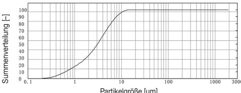
Die Messungen wurden mit einer Natrium-Chlorid-Lösung mittels Laser-Diffraktions-Methode durchgeführt.
