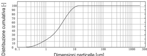
Le misure sono state effettuate con una soluzione al cloruro di sodio, per mezzo di un metodo a diffrazione laser.
