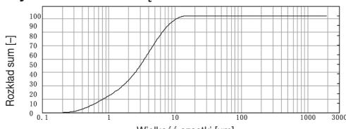
Pomiary zostały wykonane z zastosowaniem roztworu chlorku sodu, przy użyciu metody laserowo-dyfrakcyjnej.
