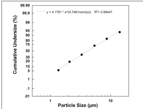
Les mesures ont été effectuées avec une solution de fluorure de sodium à l'aide d'un impacteur NGI (Next Generation Impactor).
