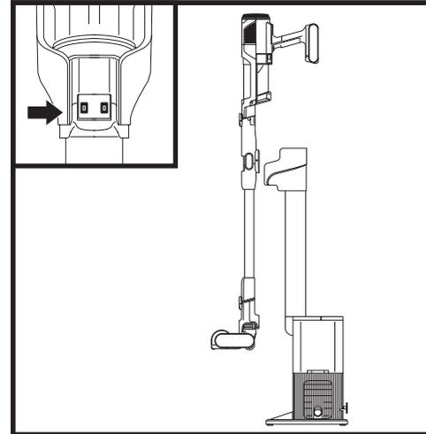
Coloca la aspiradora en la base con un movimiento descendente. Cuando esté correctamente acoplada, comenzará el proceso de autoevacuación. El ciclo de evacuación durará 15 segundos.
