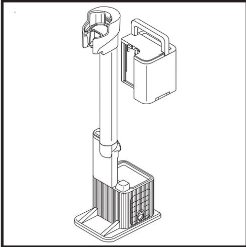
El depósito de polvo de la base tiene capacidad para almacenar polvo y residuos hasta 30 días. Vacía el depósito cuando se encienda el indicador luminoso de depósito lleno. Para retirar el depósito, levántalo sujetándolo por el asa.
