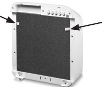
4. Coloque un nuevo filtro combinado. Para colocar el filtro combinado correctamente, guíese por las lengüetas laterales como se muestra en la imagen. Coloque el prefiltro encima.
