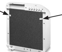
4. Inserire un nuovo filtro combinato. Per inserirlo in modo corretto, orientarsi con le linguette laterali come mostrato in figura. Posizionare il pre-filtro.
