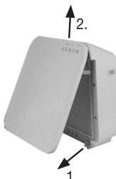
2. Cihaz kapağını şekilde gösterildiği gibi çıkarın (miknatıslı kilit). Miknatıslı kilidi önce alttan ve sonra üstten yerinden çıkarın.
