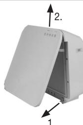
2. Retirez le couvercle du boîtier comme indiqué (fermeture magnétique). Décrochez d'abord la fermeture magnétique en bas, puis en haut.
