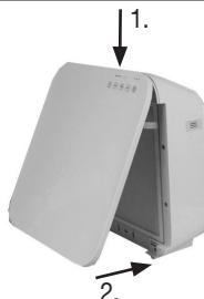
5. Vuelva a colocar la cubierta de la carcasa como se muestra en la imagen, hasta que note y oiga que encaja (cierre magnético). Enganche el cierre magnético primero arriba y a continuación abajo.
