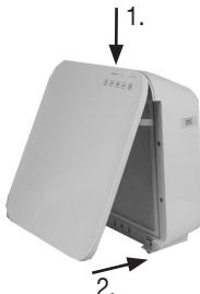
5. Proszę ponownie nałożyć pokrywę obudowy, jak przedstawiono na rysunku, aż zablokuje się w sposób słyszący i widoczny (zamknięcie magnetyczne). Proszę zawiesić zamknięcie magnetyczne najpierw na górze, a następnie na dole.
