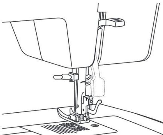
1. La palanca de elevación del prensatelas permite subir y bajar el prensatelas.
