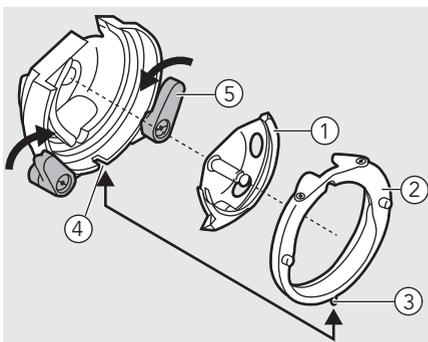
Reemplace la lanzadera. Coloque la tapa de la lanzadera asegurándose de que el pasador inferior encaje en la muesca. Vuelva a girar los dos ganchos de sujeción. Inserte el portacanillas y la canilla y vuelva a colocar la placa de puntadas.
