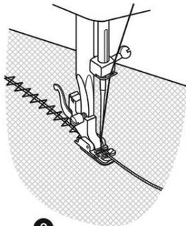
Inserte el cordón entre el resorte que recubre la ranura del cordón y el pie. El cordón debe atravesar la ranura. Se pueden coser de uno a tres cordones. La anchura de la puntada se ajusta según el número de cordones y la puntada seleccionada. (2/3)
