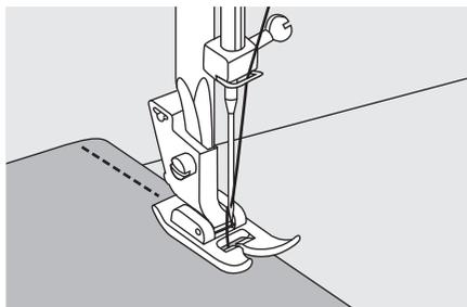
Baje la palanca de elevación del prensatelas y después presione el pedal para empezar a coser.
