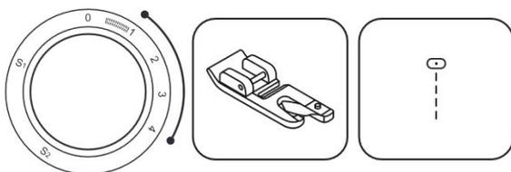
Para dobladillos en telas finas o transparentes. Ajuste la máquina tal y como se muestra en la figura.
