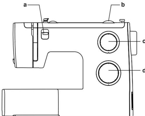
Para seleccionar una puntada, simplemente gire el selector de patrón. Puede girar el selector de patrón en cualquier dirección.
