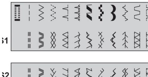
Ajuste la longitud y la anchura de la puntada en función de la tela que se utilice. Para obtener otros patrones, gire el selector de longitud de puntada a "S1" o "S2", seleccione el patrón deseado con el selector de patrón.
