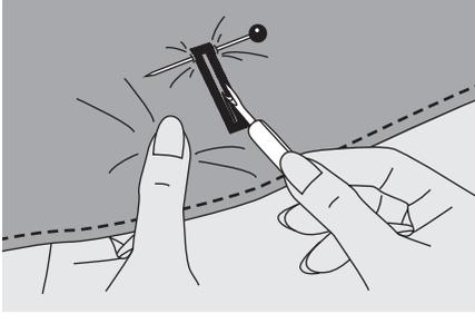
Corte el centro del ojal procurando no cortar ninguna puntada en ninguno de los lados. Utilice un alfiler en el ojal para no cortar demasiadas puntadas.
