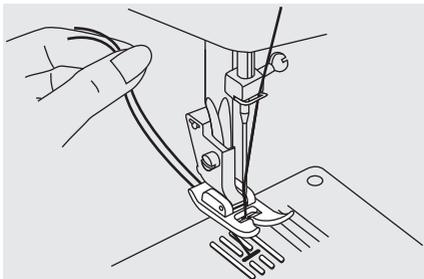
Coloque ambos hilos en la parte posterior bajo el prensatelas.
