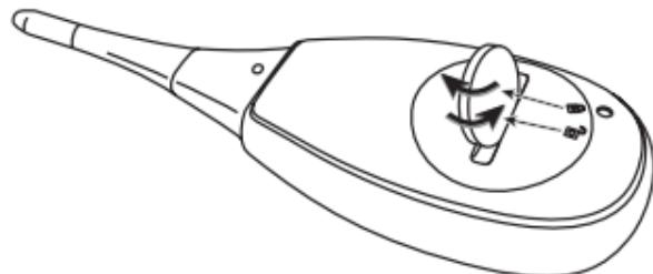
6. Закройте крышку отсека для батареек.
