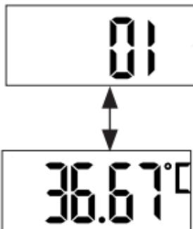
3. Kayıtlı ölçüm değerlerini gözden geçirmek için açma/kapatma tuşuna kısaca bas. Bellek menüsünden çıkmak için açma/kapatma tuşunu üç saniye basılı tut.
