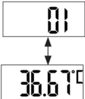
3. Um zwischen den gespeicherten Messwerten zu navigieren, drücke jeweils kurz die Ein-/Aus-Taste. Um das Speichermenü wieder zu verlassen und das Gerät auszuschalten, halte die Ein-/Aus-Taste für drei Sekunden gedrückt.
