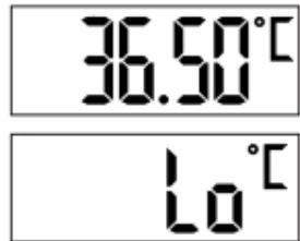
3. Ferme la bouche et respire doucement par le nez, afin que le résultat de mesure ne soit pas affecté par ta respiration. Pendant la mesure, l'écran s'éteint pour économiser la batterie et l'anneau lumineux à LED clignote lentement. La mesure se termine lorsqu'une température stable est atteinte. Un signal sonore retentit et la température mesurée s'affiche.
