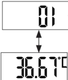
3. Para navegar entre los valores guardados, pulsa brevemente el botón de encendido, apagado. Para volver a salir del menú de memorización y apagar el aparato, mantenga pulsado el botón de encendido y apagado durante tres segundos.
