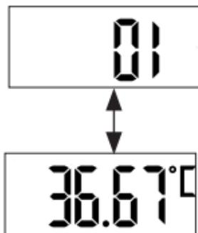
3. Для навигации по сохраненным значениям измерений коротко нажимайте кнопку «Вкл./выкл.». Для выхода из меню карты памяти и отключения прибора удерживайте кнопку ВКЛ./ВЫКЛ. нажатой в течение трех секунд.
