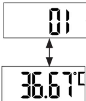
3. Aby nawigować pomiędzy zapisanymi wartościami pomiaru, krótko naciśnij przycisk włączania/wyłączania. Aby wyjść z menu pamięci i wyłączyć urządzenie, nacisnąć i przytrzymać przez trzy sekundy przycisk włączania/wyłączania.
