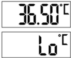
3. Сомкните губы и спокойно дышите носом, чтобы не повлиять на результат измерения выдыхаемым воздухом. В целях предотвращения разряда батарейки во время измерения дисплей выключается, а светодиодное кольцо медленно мигает. Измерение завершится, когда прибор зафиксирует стабильную температуру. Раздается звуковой сигнал, и на дисплее появится показатель измерения температуры.
