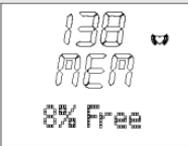
The image shows a digital display with '138' at the top, 'MEM' in the middle, and '8% Free' at the bottom. A small arrow icon is visible on the right side of the display. | Durante el entrenamiento, el pulsómetro visualiza cada 5 segundos <b>MEM x% Free</b> , si la capacidad de la memoria está bajo un 10%.<br>En la ilustración: <b>MEM 8% Free</b> (un 8% libre aún).         |
