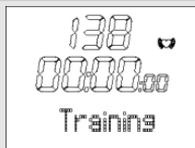
Tan pronto como accede al menú **Training**, el pulsómetro pasa automáticamente a la indicación principal, que muestra en la línea central el tiempo de entrenamiento registrado hasta ahora (después de un reinicio: 00:00:00) y en la línea inferior muestra **Start**.
