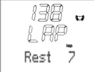
The image shows a digital display with '138' at the top, 'LAP' in the middle, and 'Rest 7' at the bottom. A small arrow icon is visible on the right side of the display.  | Durante el entrenamiento, el pulsómetro visualiza cada 5 segundos <b>LAP Rest x</b> , si hay menos de 10 rondas libres (de un total de 60).<br>En la ilustración: <b>LAP Rest 7</b> (7 rondas libres aún). |
