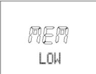
The image shows the text 'MEM' in a large, stylized font above the text 'LOW' in a smaller, standard font.                                                                 | Al acceder al menú <b>Training</b> , el pulsómetro visualiza <b>MEM LOW</b> , si la capacidad de la memoria está bajo un 10% o bien si hay menos de 10 rondas libres.                                      |
