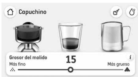
El grosor del molido afectará a la velocidad del flujo de agua a través del café en el filtro y el sabor del espresso. Configura un grosor fino, pero no demasiado.
