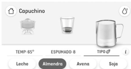
El espumado se detendrá automáticamente cuando se alcance la temperatura seleccionada.
