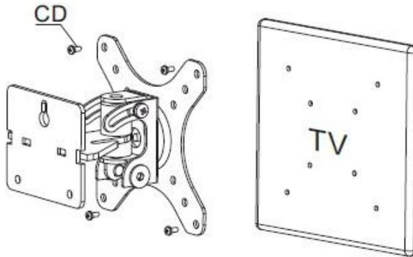
Ayudado de la herramienta apropiada, coloque los tornillos C o D, en la posición VESA requerida y asegurándose que la medida de los tornillos es la correcta y tiene la profundidad máxima requerida por el fabricante de su televisor o pantalla.
