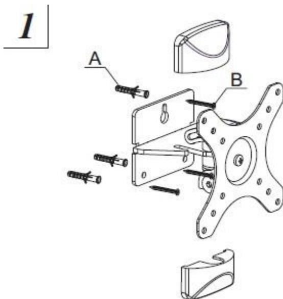
Usando un nivel de burbuja para asegurarse que la placa de la pared este nivelada, perfore previamente 3 orificios con una broca de 10 mm a 50 mm de profundidad.
