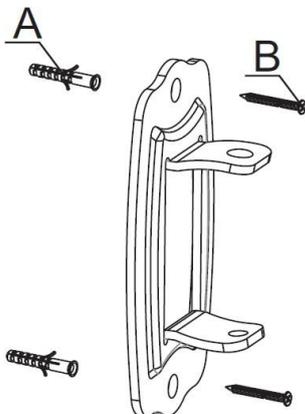
Usando el nivel de burbuja, asegúrese que la placa de pared esta nivelada, taladre dos agujeros con una broca de 10 mm y una profundidad de 50 mm. Inserte los anclajes de pared en los orificios. Luego utilice los pernos largos B y los tacos tipo A para dejar fijado a la pared la placa de sujeción principal.
