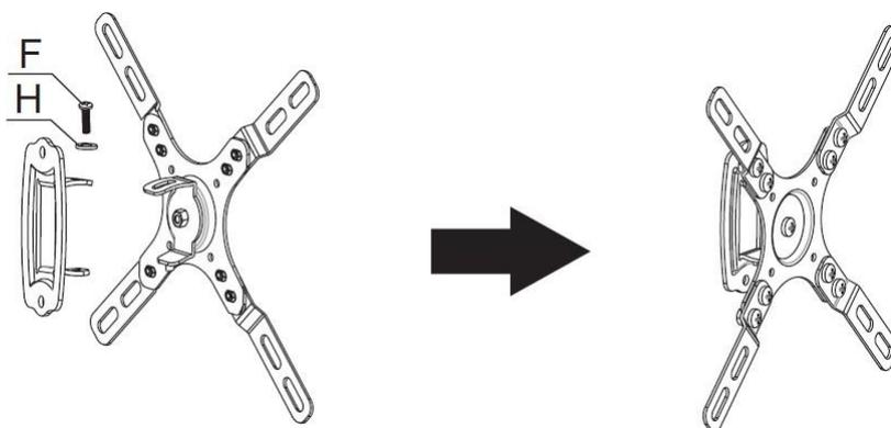
Por último, fije el soporte al brazo articulado mediante los tornillos tipo F. Recuerde siempre utilizar la arandela H para asegurar la fijación. Asegúrese que el resultado del montaje es igual al de la imagen final.
