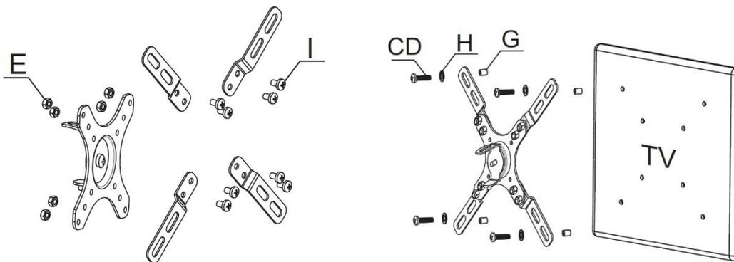
En caso de que su televisor requiera un sistema de fijación VESA superior a 100x100, coloque las aspas accesorias en la base, utilice para ello los tornillos I y las tuercas E correspondientes.
