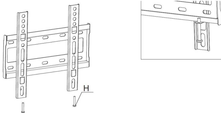
Cuelgue el televisor en la fijación de la pared y asegure que no se mueva con el tornillo tipo H, apriete con cuidado hasta encontrar la posición en que las barras queden fijas y no se desplacen.
