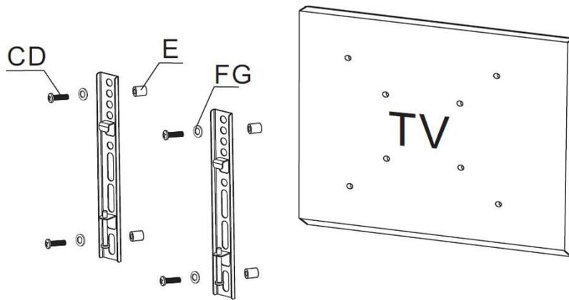
Fije las barras de sujeción a la televisión. Utilice los tornillos C o D (dependiendo de la métrica de su TV) para fijar la tv a su soporte. No olvide colocar entre el soporte y el tornillo la arancela tipo F o G (dependiendo de la métrica) y finalmente, en caso de que sea necesario, con el tope de goma tipo E.
