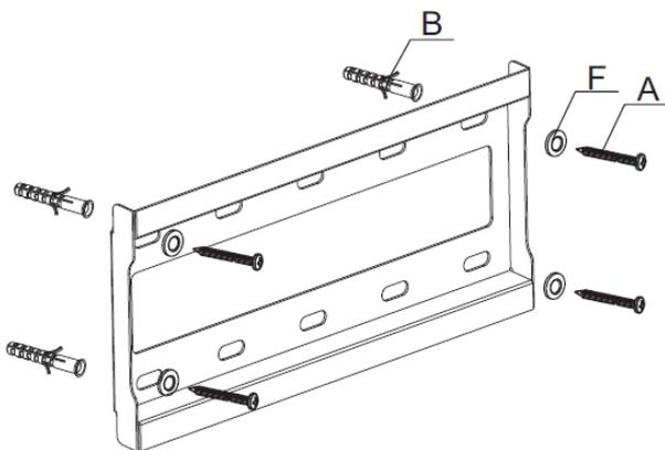
Usando el nivel de burbuja, asegúrese que la placa de pared esta nivelada, taladre dos agujeros con una broca de 10 mm y una profundidad de 50 mm. Inserte los anclajes de pared en los orificios. Luego utilice los pernos largos A y los tacos tipo B para dejar fijado a la pared la placa de sujeción principal. Recuerde colocar la arandela F entre la placa de la pared y los pernos.
