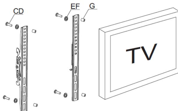
Fije las barras de sujeción a la televisión. Utilice los tornillos C o D (dependiendo de la métrica de su TV) para fijar la tv a su soporte. No olvide colocar entre el soporte y el tornillo la arancela tipo E o F (dependiendo de la métrica) finalmente, en caso de que sea necesario, con el tope de goma tipo G.
