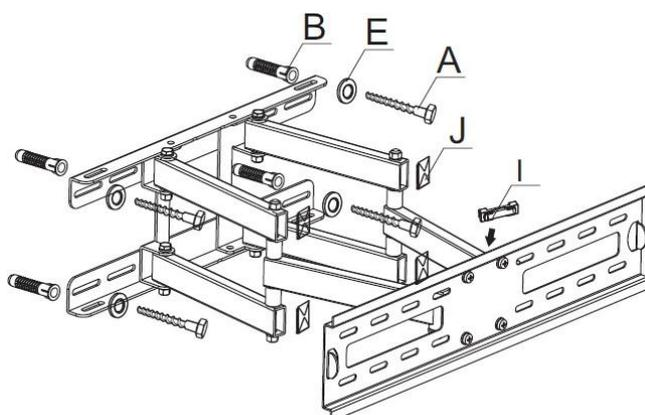
Usando el nivel de burbuja (I), asegúrese que la placa de pared esta nivelada, taladre dos agujeros con una broca de 10 mm y una profundidad de 50 mm. Coloque los tacos B y fije el soporte con los tornillos A. Coloque la arandela E para evitar movimientos y que el tornillo se desplace. Lo protectores J, deben quedar montados antes de fijar su televisión.
