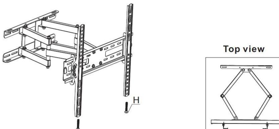
Introduzca el cableado de su televisor a través de la parte central del soporte, después cuelgue el televisor en la fijación de la pared y asegure que no se mueva con el tornillo tipo H, apriete con cuidado hasta encontrar la posición en que las barras queden fijas y no se desplacen.
