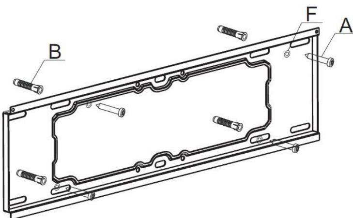
Usando un nivel de burbuja, asegúrese que la placa de pared esta nivelada, taladre dos agujeros con una broca de 10 mm y una profundidad de 50 mm. Coloque los tacos B y fije el soporte con los tornillos A. Coloque la arandela F para evitar movimientos y que el tornillo se desplace.
