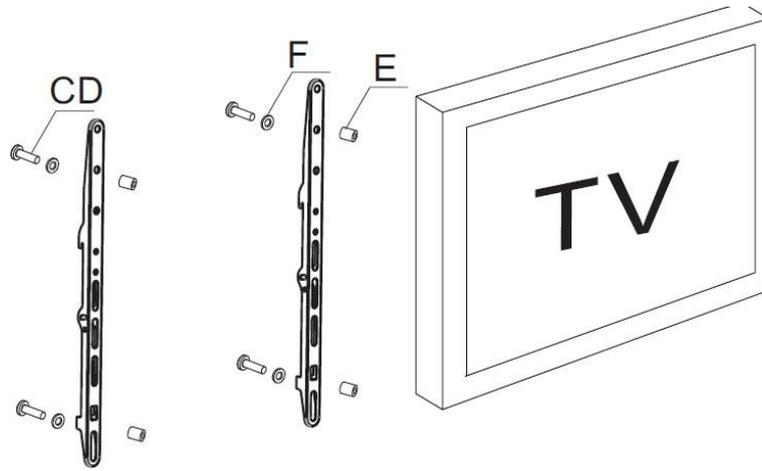
Fije las barras de sujeción a la televisión. Utilice los tornillos C o D (dependiendo de la métrica de su TV) para fijar la tv a su soporte. No olvide colocar entre el soporte y el tornillo la arancela tipo F finalmente, en caso de que sea necesario, con el tope de goma tipo E.
