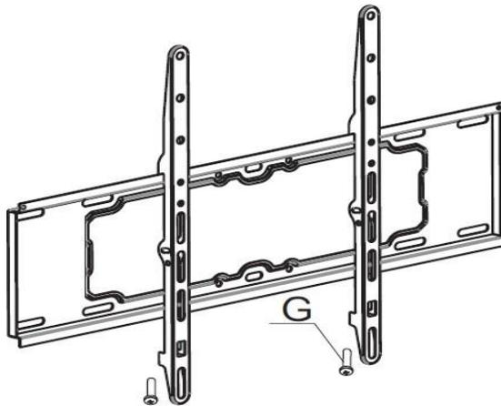
Utilice los Tornillos G para fijar las barras centrales a soporte y de esta manera evitar que se desplace o se descuelgue la televisión. Efectué una presión suave en cada tornillo hasta encontrar el punto idóneo de fijación. No fuerce en ningún caso el tornillo una vez haya llegado al tope.
